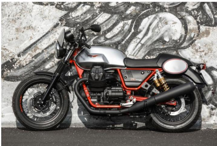
一方、新しいフロントナンバープレートはブラシ仕上げのアルミニウム製ですスポーツホイールのリムには、他のスポーツモデルと同様に、ブラックリムにモト・グッズの赤いステッカーが貼られています。塊から削り出された後退したフットペグ、軽量化されたステアリングステム、ステアリングトップブリッジガードも目を引く高級コンポーネントです。最も重要な技術的革新は、スポーツライディングにおける優れたパフォーマンスを約束する、スプリングブリロードとリバウンドおよびコンプレッションダンピングの調整が可能な、オーリンズ製ショックアブソーバーを採用したことです。
