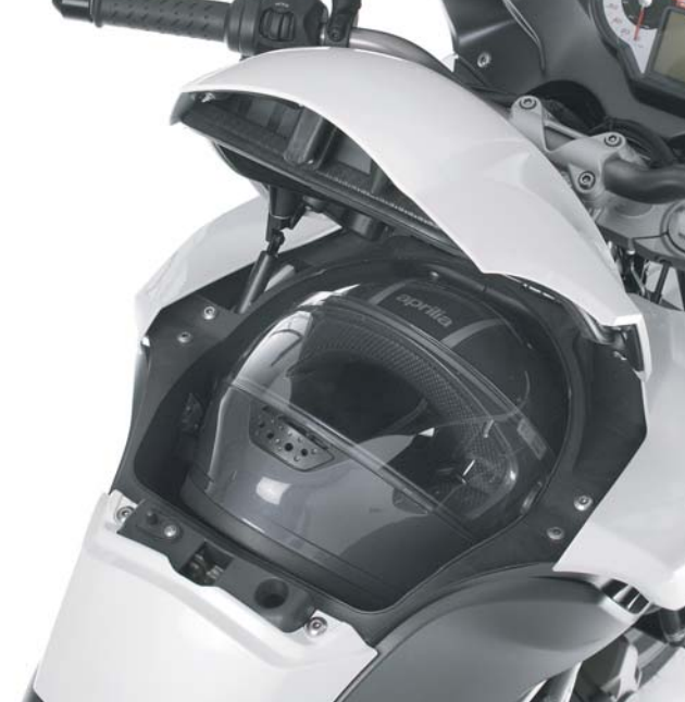
通常ガソリンタンクがある位置はフルフェイスヘル メットが収納可能なスペースを確保。またスペース 内に12V電源ソケットを装備。
