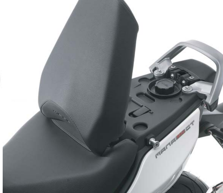
モーターサイクルでありながらメットインを実現させるため 燃料タンクをシート下に配置。
